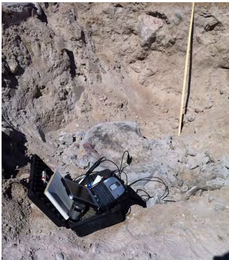
Figur 17. Seismiskmätning i fält på jetpelare nummer 20C.
