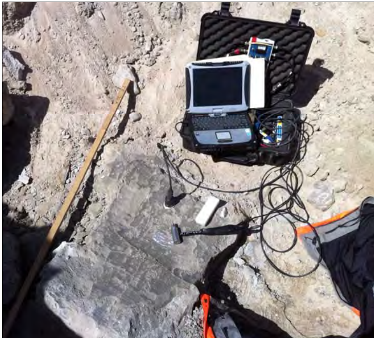
Figur 12. Seismisk mätning i fält på jetpelare nummer 10A.
