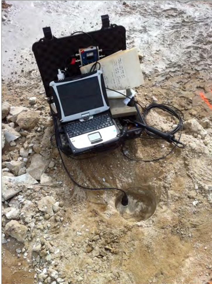
Figur 19. Seismiskmätning i fält på jetpelare nummer P183.
