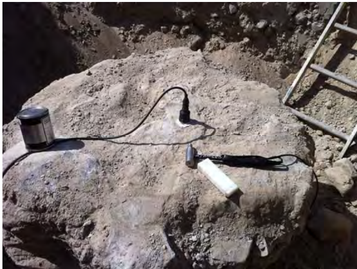
Figur 15. Seismiskmätning i fält på jetpelare nummer 20A.
